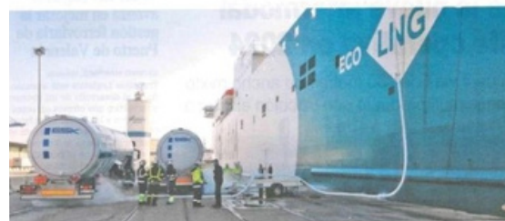
Operativa de suministro de Gas Natural Licuado para la naviera Baleárica, principal cliente de Grupo ESK. Foto: Baleárica
